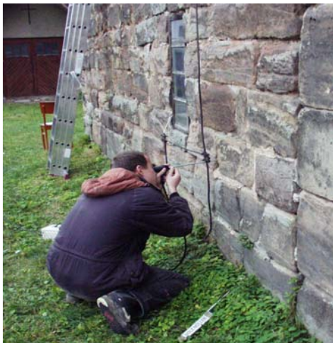
Endoskopieuntersuchungen am mehrschaligen Mauerwerk
