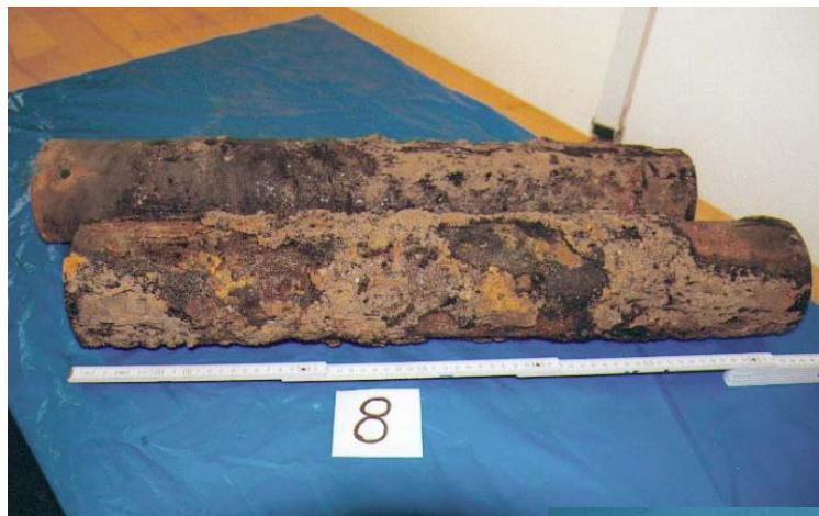
Rohrprobe mit starker Graphitierung Erneuerung der Rohrstrecke erforderlich
