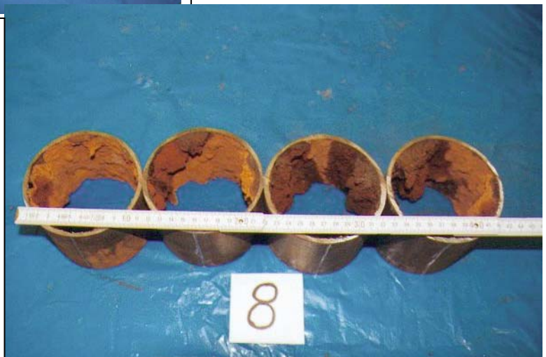
Rohrprobe mit starker Graphitierung Erneuerung der Rohrstrecke erforderlich
