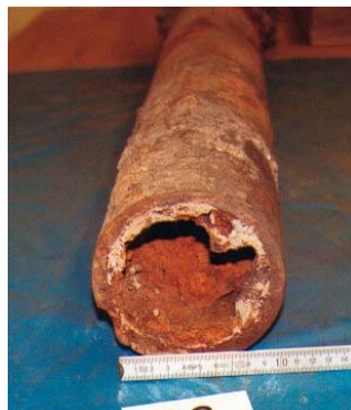
Rohrprobe mit starker Graphitierung Erneuerung der Rohrstrecke erforderlich
