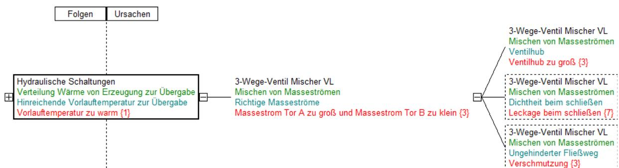
Abbildung 2-9: Beispiel Fehlernetz einer Beimisch-Schaltung für differenzdruckarme Verteiler oder WE ohne eigener Pumpe
