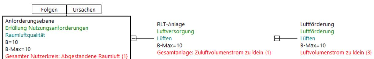
Abbildung 2-30: Fehlernetz RLT-Anlage Grundstruktur: Anforderungsebene Gesamter Nutzerkreis Abgestandene Raumluft
