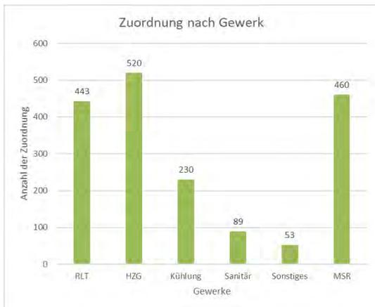
Abbildung 1-1: Fehler nach Gewerken
