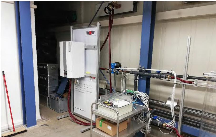
Abbildung 4-2: Foto der Inneneinheit des Kältesystems mit Messtechnikausstattung
