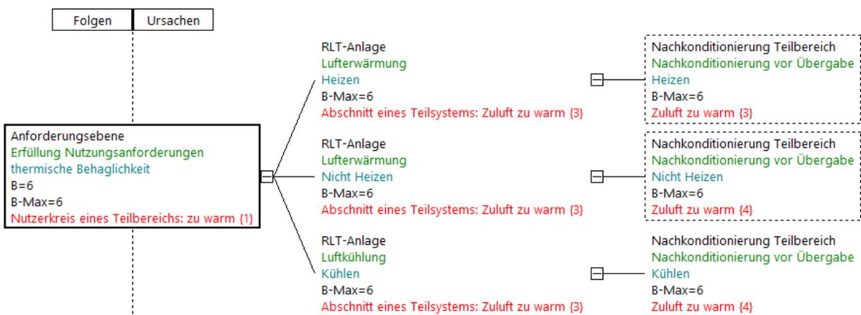
Abbildung 2-24: Fehlernetz RLT-Anlage Grundstruktur: Anforderungsebene kleiner Nutzerkreis zu warm
