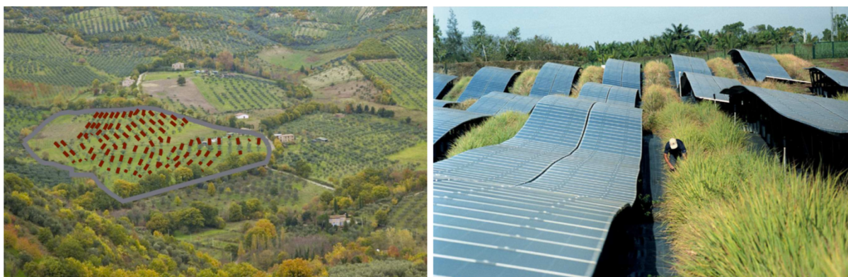
Abbildung 54: Integrativer Gestaltungsansatz von APV-Anlagen. (a) Mosaik-Anordnung angepasst an natürliches Landschaftsbild, (b) Bodennahe Anlagen, die der natürlichen Linienstruktur der Landschaft folgen (Scognamiglio 2015).
