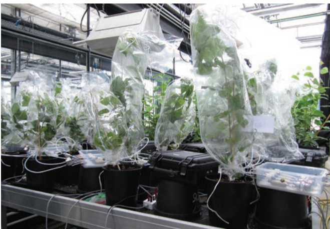
Versuchsordnung von Pappelsteckhölzern zur Duftstoffmessung im Forschungsgewächshaus
