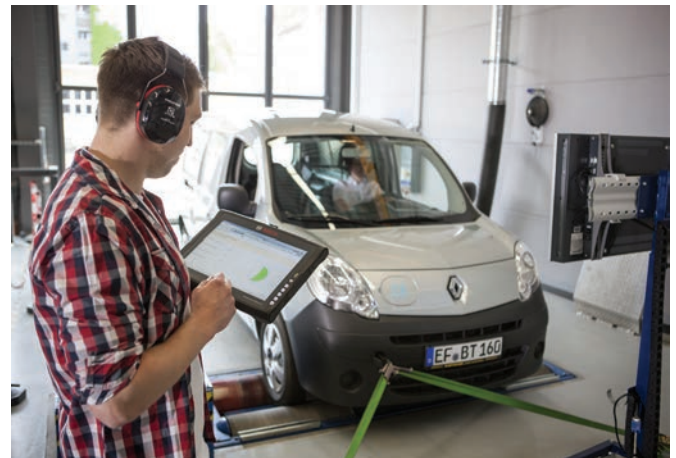
Messfahrt mit dem Elektrofahrzeug auf dem Prüfstand
