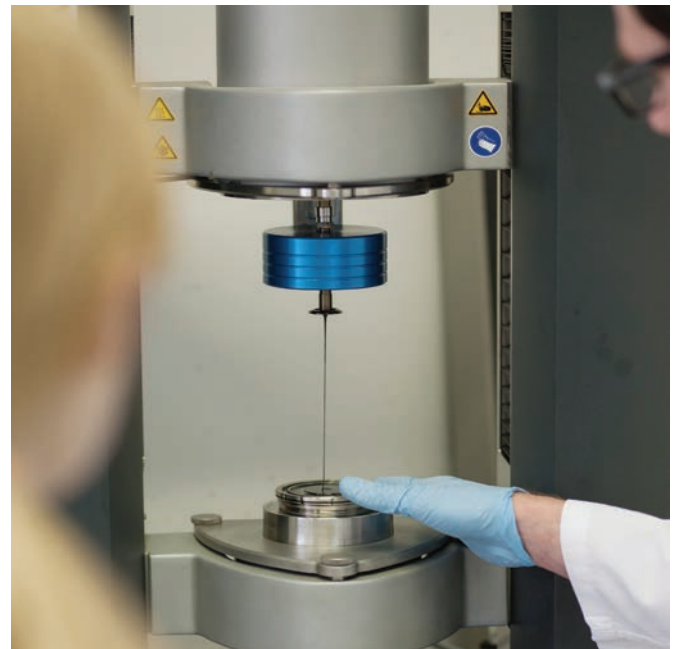
Bestimmung von Werkstoffkennwerten von Bitumen (Foto: J. Hauspurg) mit dem Scherrheometer im Straßenbaulabor
